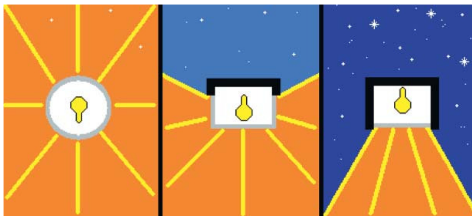
Abb. 4: Möglichkeiten der Abschirmung einer Lichtquelle nach Aue, H. et al. (2003)
